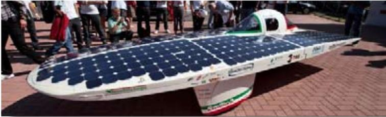
Si tratta infatti di un'auto solare costruita interamente in carbonio, kevlar e nomex e alimentata da 401 celle fotovoltaiche al silicio per una superficie di quasi sei metri quadrati. **Emilia II** è realizzata da Onda Solare, una squadra
